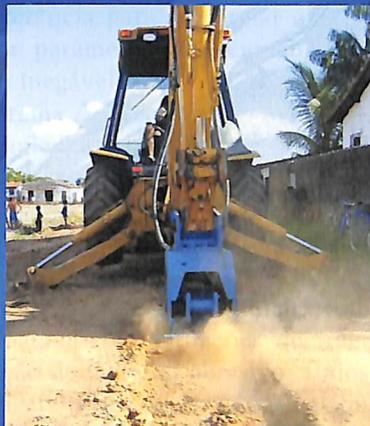
**ESTAPAC** é um compactador / estaqueador vibratório operado hidráulicamente que vai dar múltipla utilidade às suas máquinas hidráulicas, que podem ser de pequenas retros até grandes escavadeiras. Robusto e versátil, **ESTAPAC** pode ser trocado pela caçamba da máquina em minutos. É ideal para compactação em valas, rampas ou declives, e também como bate-estaca oferecendo um estaqueamento rápido e econômico.
