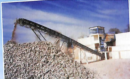
Correias transportadoras: desgaste varia de acordo com o tipo de material transportado
