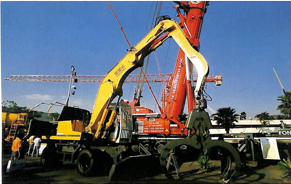
Escavadeira hidráulica sobre rodas A924 Litronic, para sucata metálica e madeira.
