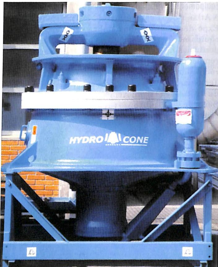
Britador Hydrocone: regulagem de abertura com carga.
