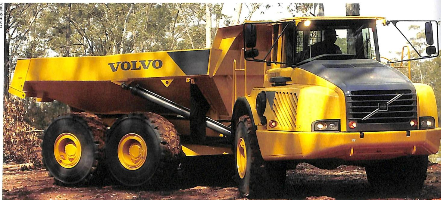
Capacidade de carga de 28 toneladas, alto torque em baixas rotações, e facilidade de manobra em terrenos acidentados.
