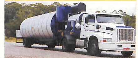
Conjunto de Estocagem e Aquecimento ROAD THERM
