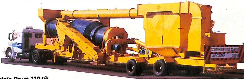
Triple Drum 110 t/h, a usina para misturas especiais
