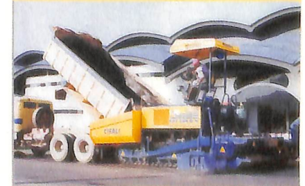
Vibro Acabadora VDA 600 BM com eletrônico de nível
