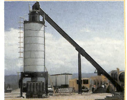
Silo de Estocagem Fixo 100 ton com aquecimento
