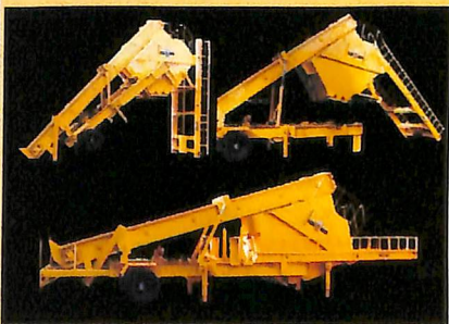
Silo de estocagem 10 m 3 auto eregível hidráulico
