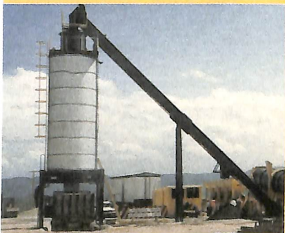
Silo de Estocagem Fixo 100 ton com aquecimento
