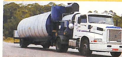
Conjunto de Estocagem e Aquecimento ROAD THERM
