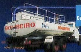
Tanque para Água com Canhão de Combate a Incêndio
