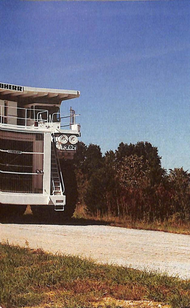
El motor diesel/eléctrico T282, de 360 t
