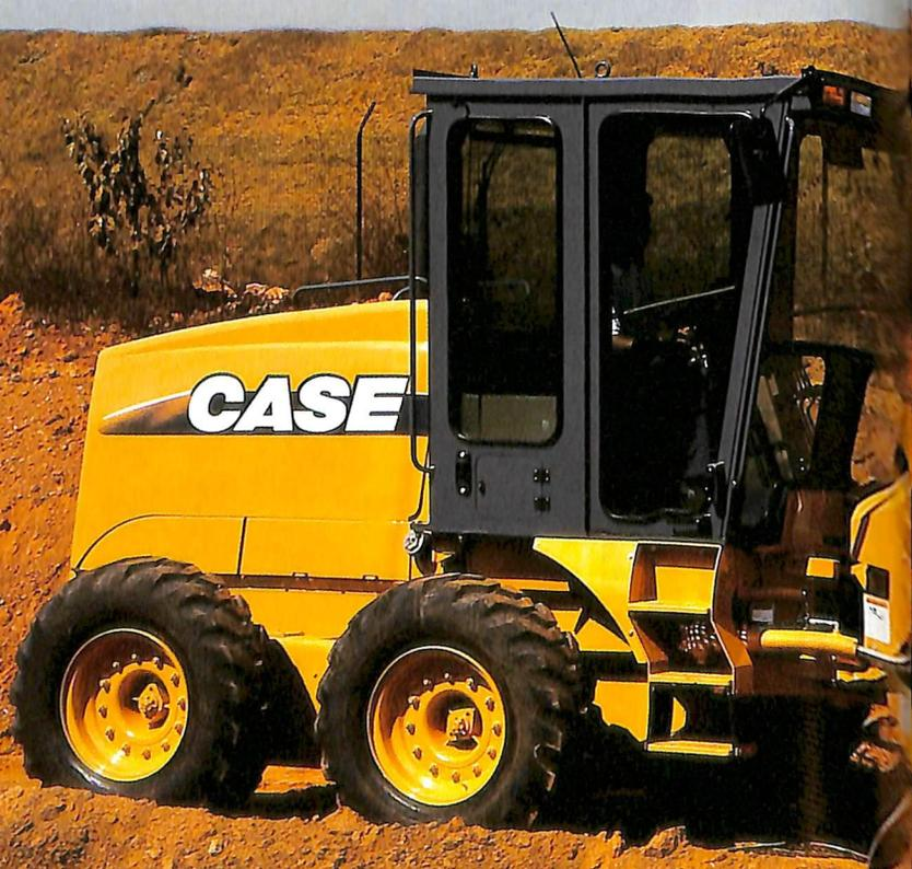
to em setembro de 2002 da motoniveladora 845, fabricada em Contagem (MG). Dos dez modelos 845 adquiridos pela própria Brasif, por exemplo, todos estão atualmente em operação – a maioria alugada para usinas de cana de São Paulo. Quatro estão mobilizadas na Usina da Pedra, onde fazem abertura e conservação de curvas de nível na plantação, abrindo também valas transversais para controlar a erosão dos solos, dos carreadouros (vias localizadas entre a plantação) e aumentar a umidade do solo.
