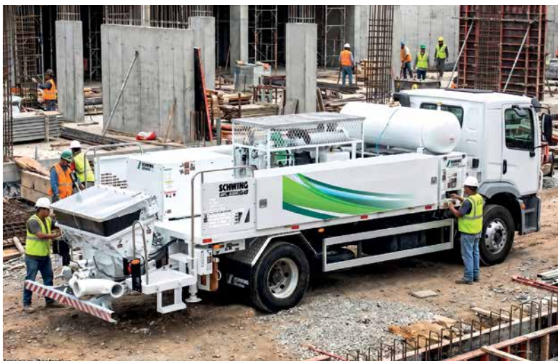
A nova autobomba SPL 2000 traz sistema exclusivo de bombeamento sem lança
