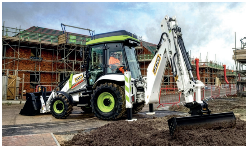
Com motor de 55 kW a hidrogênio , retroescavadeira 3CX Hydrogen promete potência e torque equivalentes ao diesel
