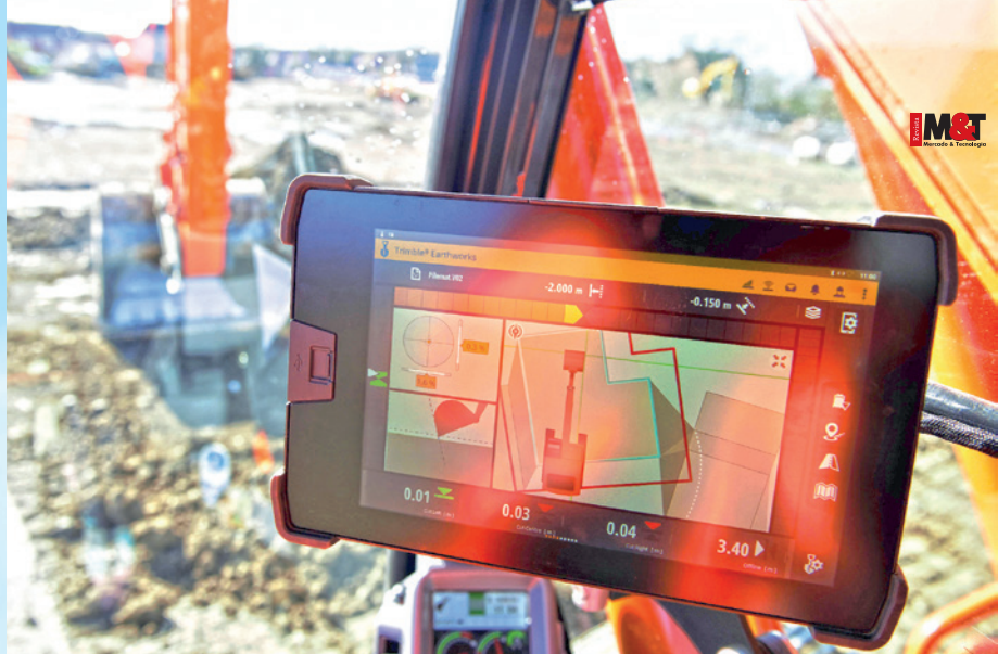
Automatização complementa os movimentos iniciados pelo operador de escavadeiras
