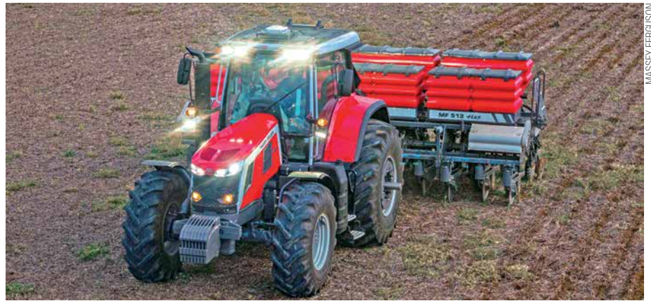
Atração da Massey Ferguson , o trator MF 6M sai de fábrica com tecnologias como piloto automático e conectividade
