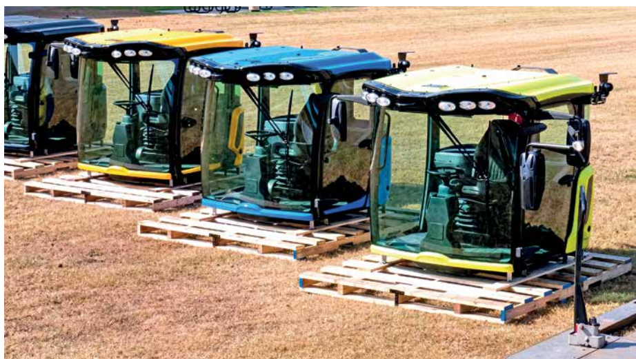
A estrutura ROFS/FOPS pode ser descrita como uma estrutura rígida composta por tubos
