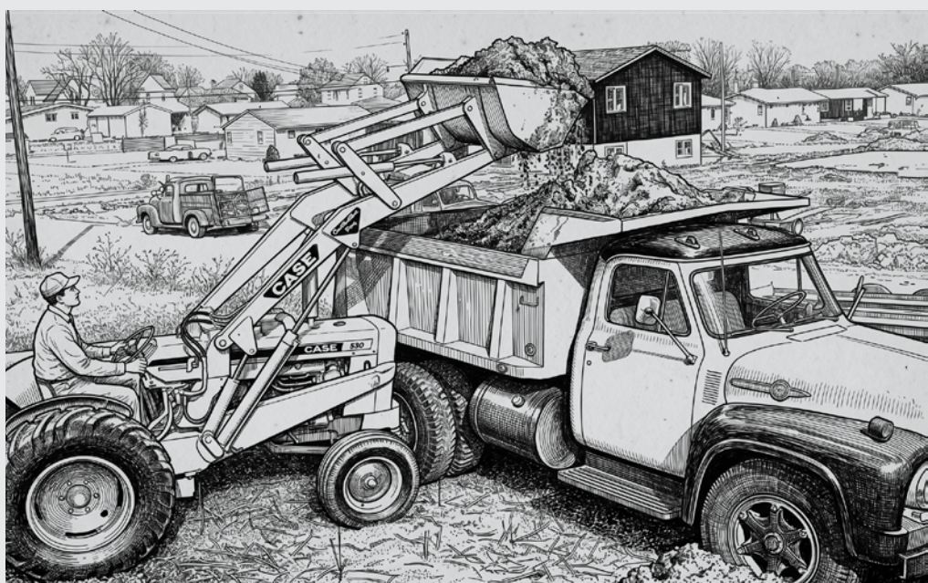
Lançado em 1963 , o conceito Case 530 Construction King contava com sistema de carregamento já integrado ao chassi
