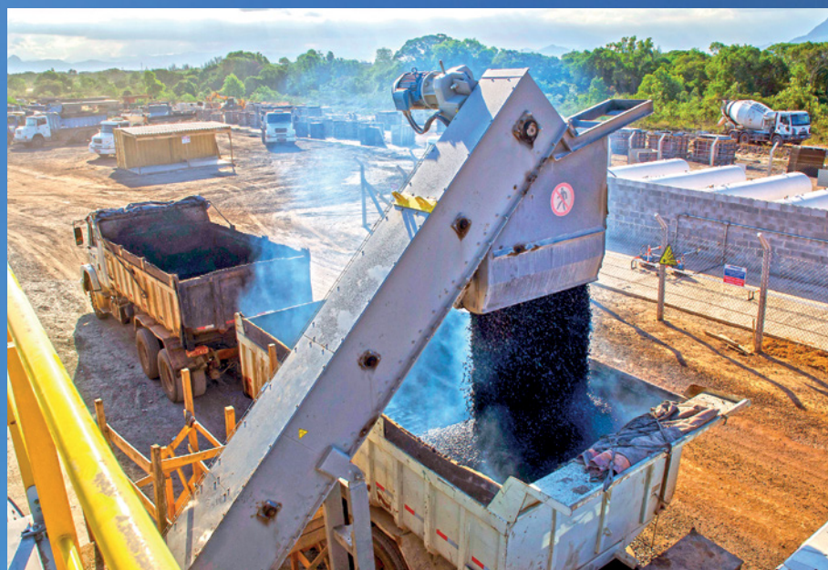
Teor de ligante, granulometria e umidade mudam conforme a origem do reciclado
