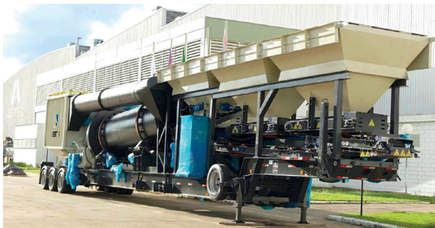
**Usina móvel Ventura 140** traz sistema de secagem e aquecimento por tambor de contrafluxo com queimador multicomcombustível
