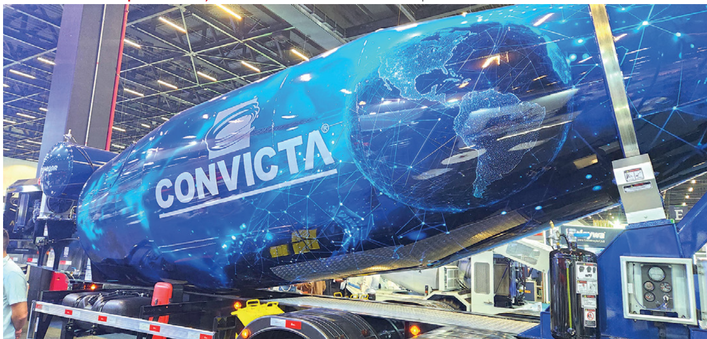
Montada sobre semirreboque de três eixos , a betoneira rebocável Convicta C-14.000 R tem capacidade de 14 m 3
