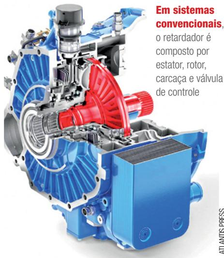
**Em sistemas convencionais,** o retardador é composto por estator, rotor, carcaça e válvula de controle
