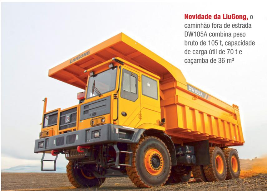
**Novidade da LiuGong**, o caminhão fora de estrada DW105A combina peso bruto de 105 t, capacidade de carga útil de 70 t e caçamba de 36 m<sup>3</sup>
