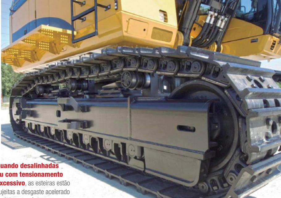
**Quando desalinhas ou com tensionamento excessivo**, as esteiras estão sujeitas a desgaste acelerado ou falhas mecânicas
