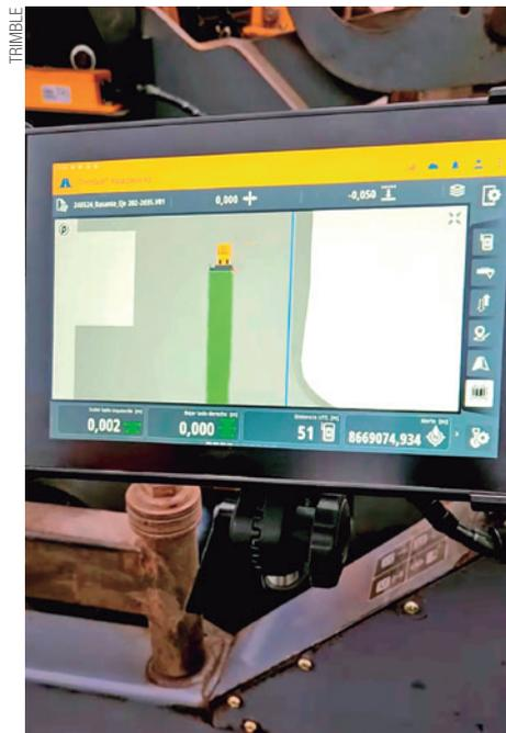
**Por meio de sensores ópticos e estações robóticas**, sistema 3D compara a posição da máquina ao modelo
