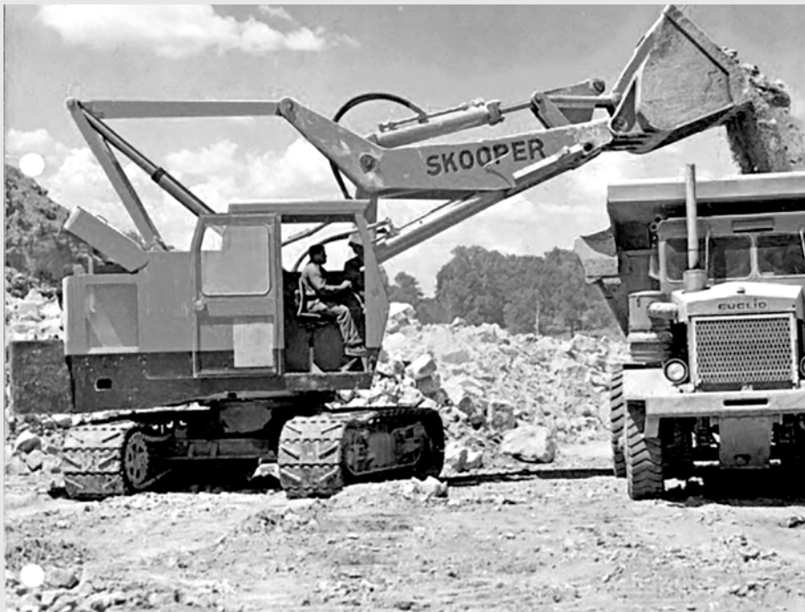
Com 27 ton , o modelo Menck-Skooper M300H tinha capacidade de 2,7 m 3 e foi produzido até 1971
