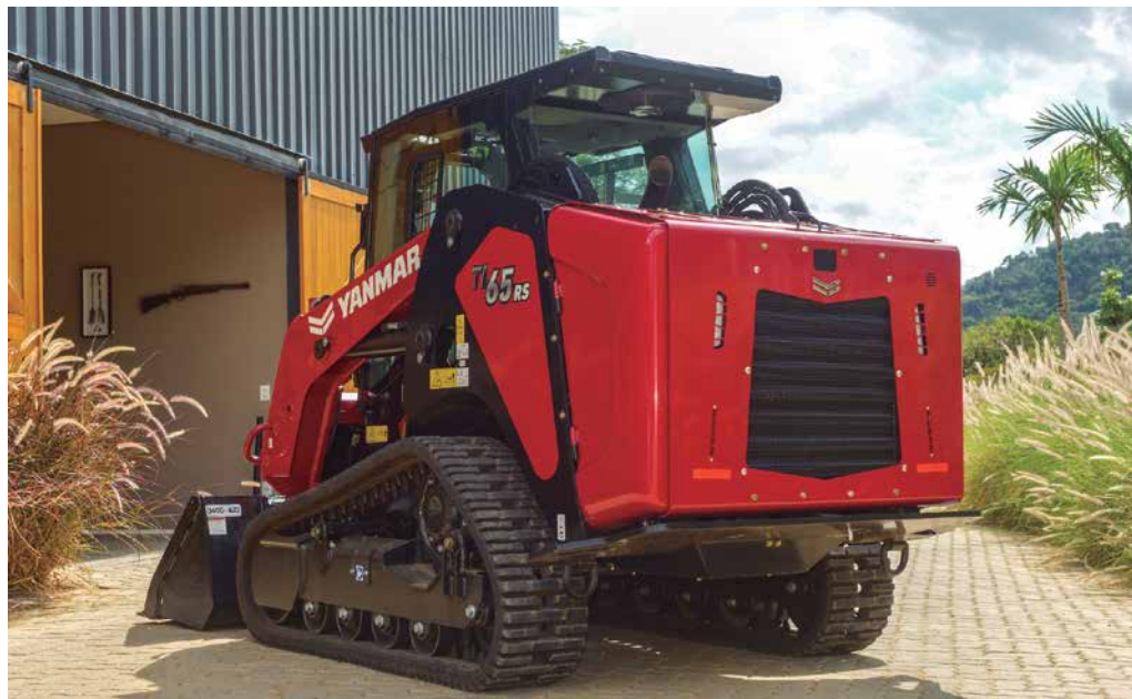
Com motor a diesel de 67 hp, o modelo TL65RS possui peso operacional de 4.044 kg
