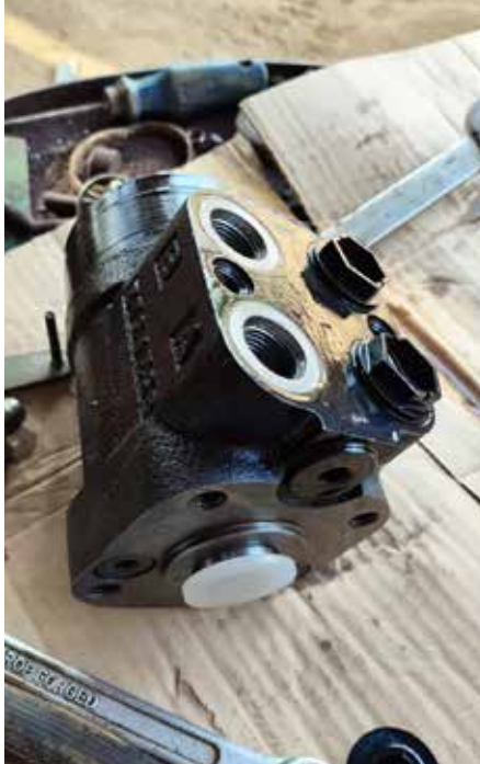
Comandado pelo volante , o orbitrol impulsiona o óleo para fazer com que o equipamento se movimente na direção desejada
