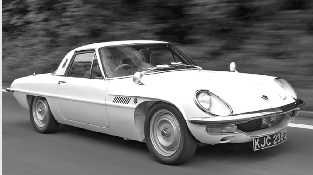
Primeiro veículo da Mazda , o modelo Cosmo tinha motor de alumínio de dois rotores e 110 cv, mantendo-se em produção por cinco anos na década de 1960
