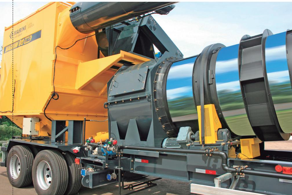
**Equipado com queimador**, o tambor fornece a energia térmica necessária para retirar a umidade dos agregados
