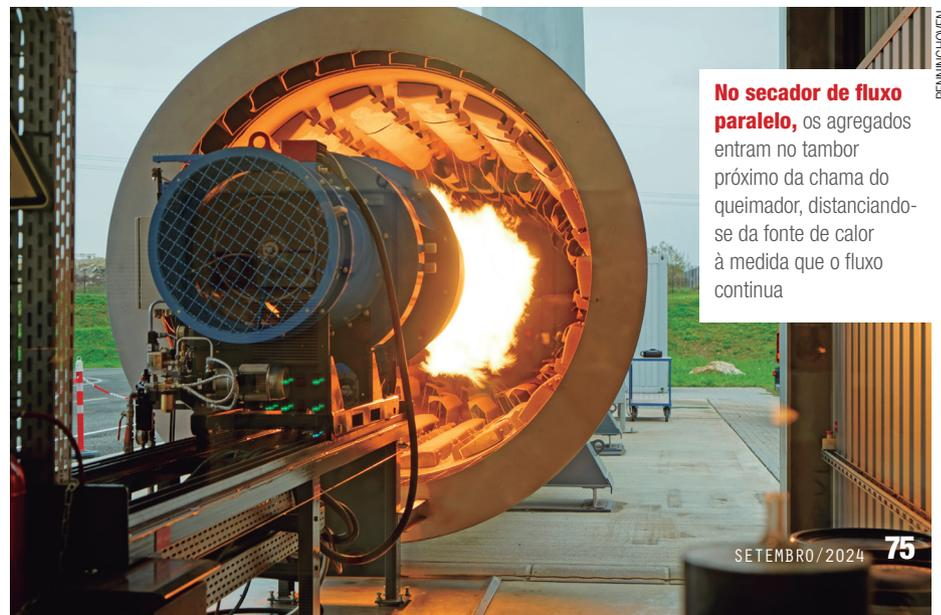
**No secador de fluxo paralelo**, os agregados entram no tambor próximo da chama do queimador, distanciando-se da fonte de calor à medida que o fluxo continua
