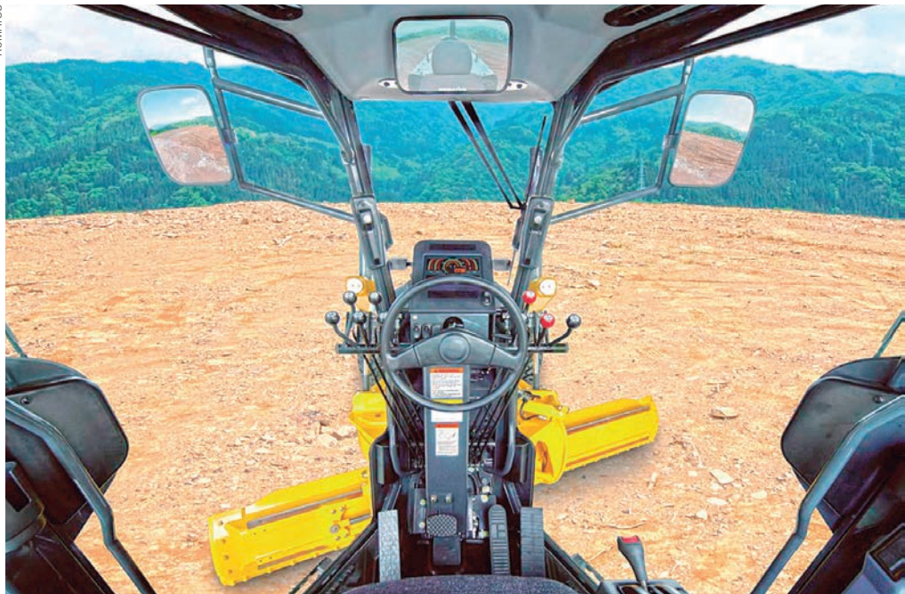
Configuração hexagonal aumenta a visibilidade da área de trabalho a partir da cabine
