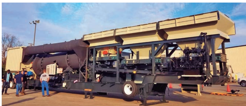
Aposta da Astec no Brasil , a usina Ventura 140 permite incorporar até 15% de material fresado
