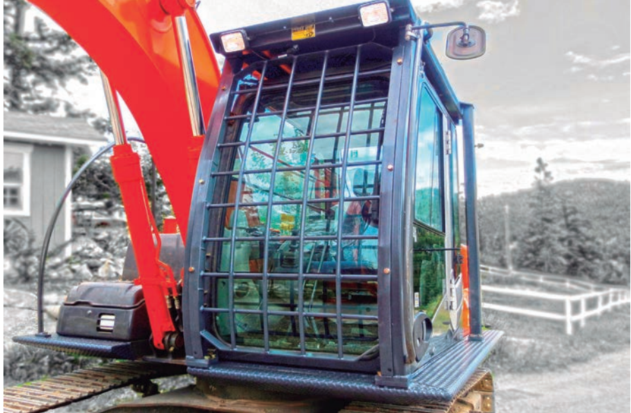
Proteções especiais da cabine previnem acidentes por inexperiência, falta de treinamento ou descuido
