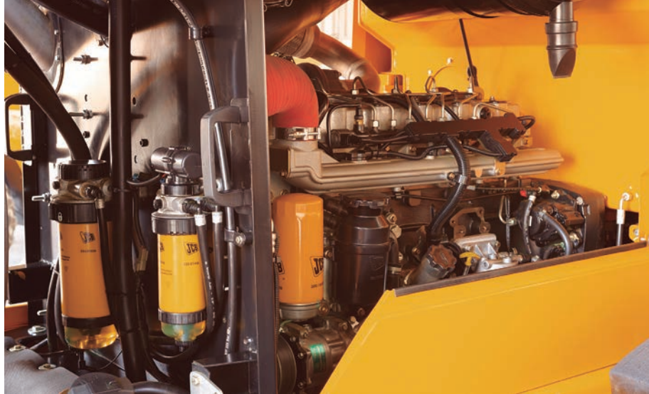
Com 221 hp e torque de 1.000 Nm , motor diesel Tier III promete potência e torque elevados em baixa rotação
