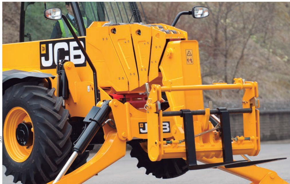
Estabilizadores devem ser utilizados em içamentos de cargas sensíveis ao movimento
