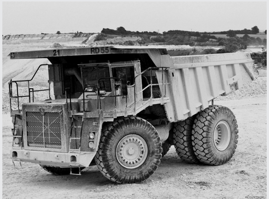
Introduzido pela Aveling-Barford , o modelo basculante RD55 se destacava pela capacidade de 55 ton
