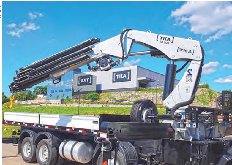
Novidade da TKA , o guindaste tipo trave 50700 promete espaço reduzido de montagem
