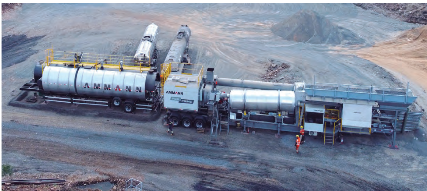
Com sistema de duas células , a usina ACM Prime 2.0 da Ammann promete alta precisão de dosagem
