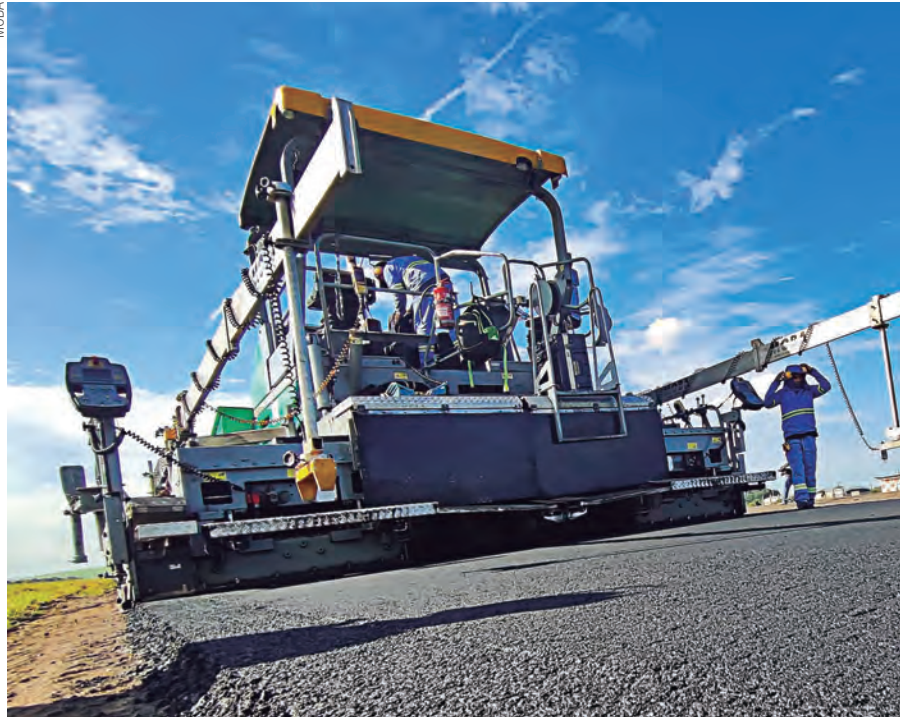
O sistema de nivelamento Big Sonic-Ski está entre os destaques para pavimentação da Moba
