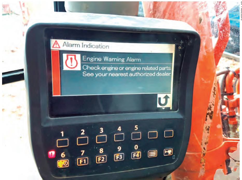
Sistemas de gerenciamento exibem no painel problemas relacionados aos módulos eletrônicos
