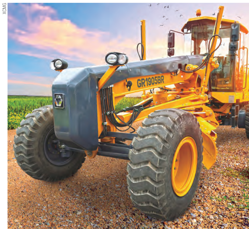
Com lâmina de 3.660 mm, a motoniveladora GR1905BR é atração no estande da XCMG
