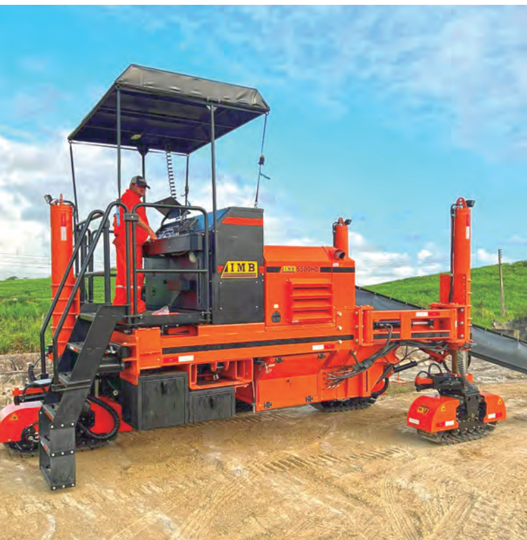
Desenvolvida no Brasil , a pavimentadora de concreto da IMB é voltada para obras até 5 m de largura
