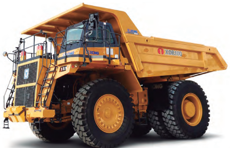
O caminhão de mineração XDR100 oferece capacidade de carga 91 toneladas e peso total carregado de 158 toneladas, com capacidade cúbica de até 60 m 3 na caçamba
