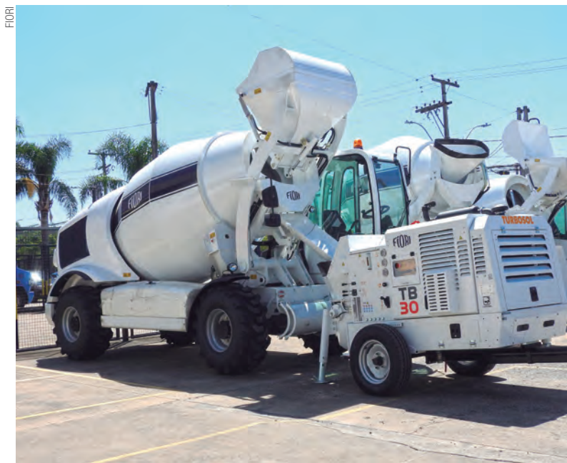
Com capacidade de 4 a 30 m 3 /h, a bomba de concreto TB30 ganha destaque no estande da Fiori
