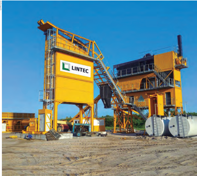
A Lintec & Linnhoff promove usinas misturadoras de asfalto em contêineres como o modelo CSD1200
