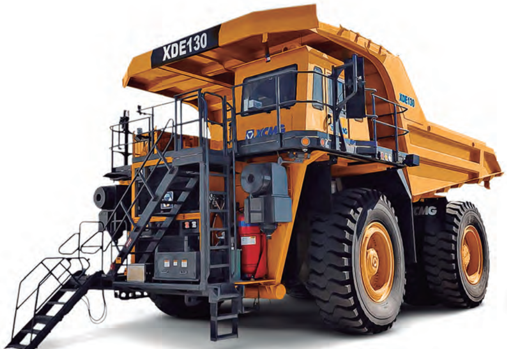
Com caçambas de 68 m 3 a 73 m 3 de capacidade , o modelo diesel-elétrico XDE130 tem capacidade de carga de 120 toneladas e peso total carregado de 205 toneladas
