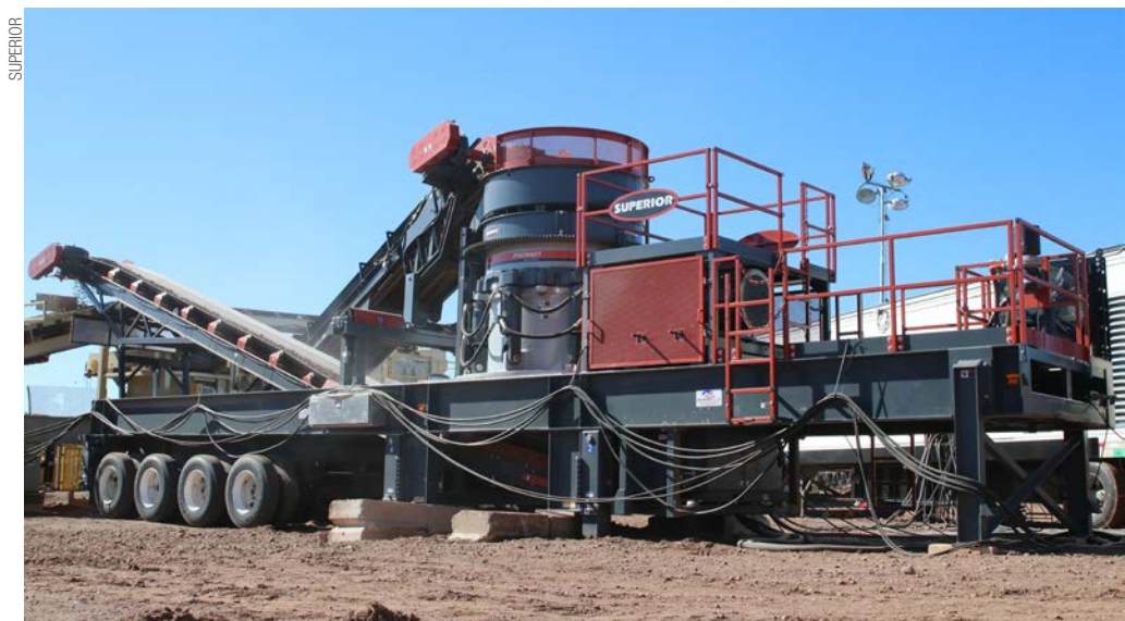
Planta móvel de britagem é usada em situações que não demandam produções elevadas
