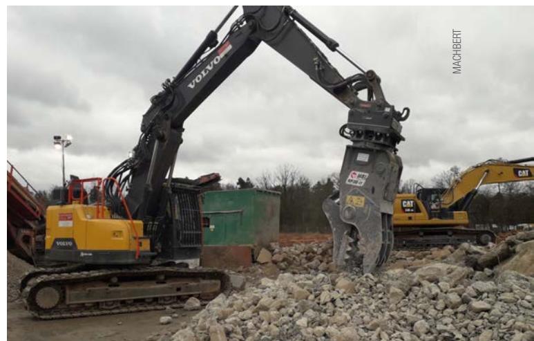
Kits possibilitam a adição de linha hidráulica adicional para uso de implementos
