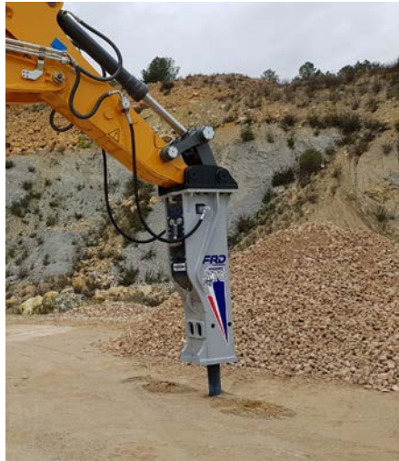
Modelos em corpo monobloco eliminam problemas com tirantes de fixação
