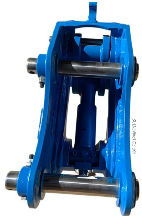
Acoplagem do implemento à máquina pode ser agilizada com o uso de engates rápidos
