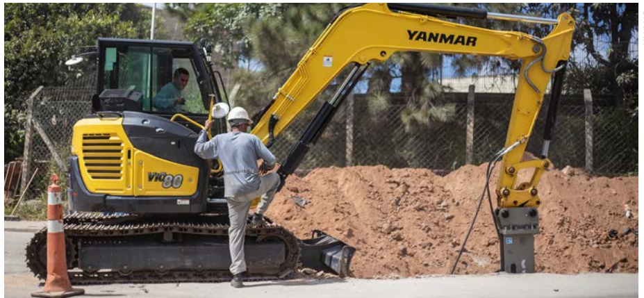
Análise da viabilidade de conexão do implemento à máquina deve levar em consideração a relação entre peso e fluxo hidráulico
