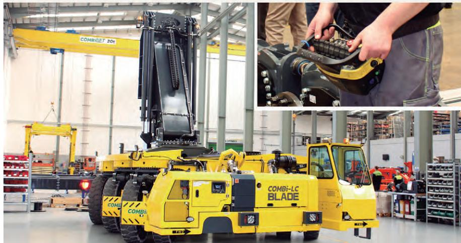
**Com controle remoto, modelo 14Tonnes** (imagem superior) é indicado para a instalação de painéis de concreto, enquanto a solução Combi-LC Blade Mover é voltada para o segmento de energia eólica offshore
