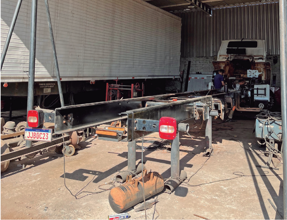
Serviços também abrangem instalação de terceiro eixo e quarto eixo direcional
