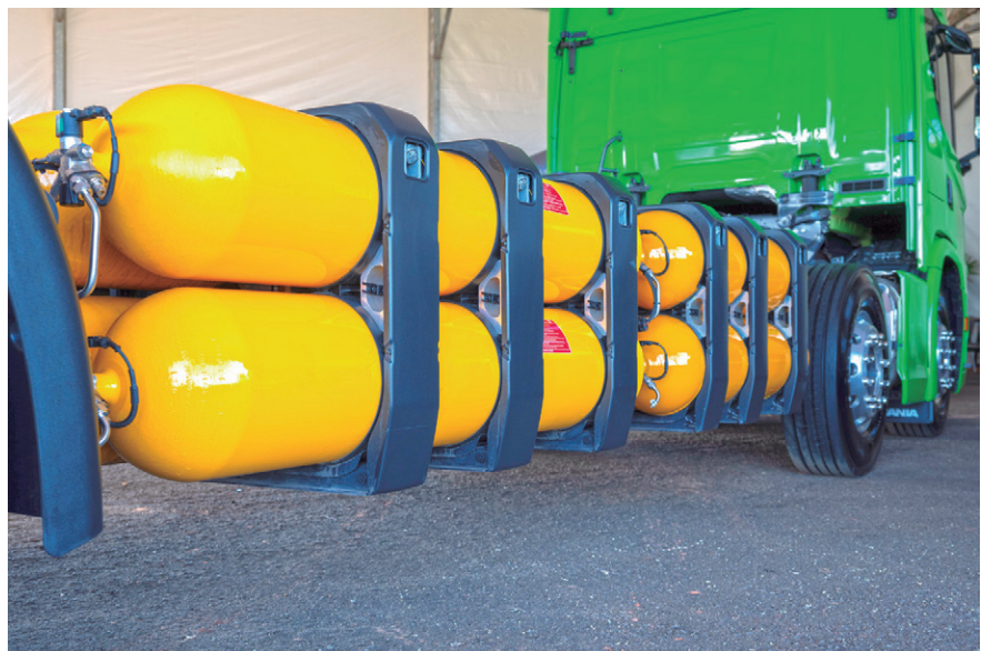
Com motor de 410 cv, modelo X-gas acomoda 16 cilindros de gás nas laterais da longarina
