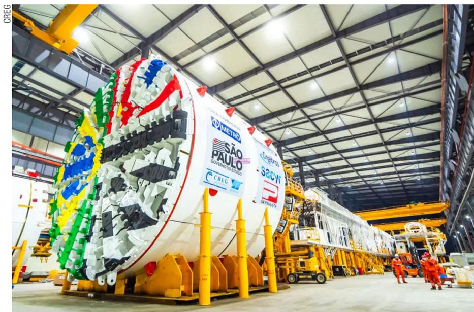
Com 11,6 m de diâmetro, tuneladora deve avançar 15 m/dia em solo misto na primeira fase da obra
