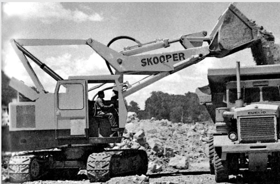
Montado sobre a mesma base da retroscavadeira 505, o modelo Koehring Skooper K505 trazia caçamba de 3 m<sup>3</sup> e motor de 255 hp
