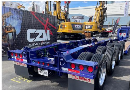
Destaque no estande da empresa na ConExpo 2023, o semirreboque 60CC-RC de quatro eixos oferece convés reforçado e opções aprimoradas de distribuição de peso. Com projeto “pescoço de ganso” personalizável, o modelo traz deck de 8,5 m de comprimento e sistema de acoplamento com opção para adição de um quinto eixo, informa a fabricante.
