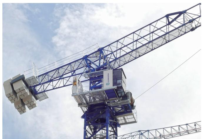
**Comansa apostou na nova grua** hidráulica LCH300 com alcance de 60 m
