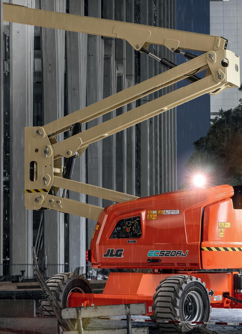
Agora você pode trabalhar em áreas delicadas sem perturbar o ambiente. Alimentado por baterias de íon de lítio de carregamento rápido e dois motores elétricos, as EC Booms da JLG oferecem operações limpas e maior eficiência energética em qualquer local de trabalho. Experimente um desempenho incomparável com a flexibilidade para trabalhos internos ou externos com uma única máquina.
