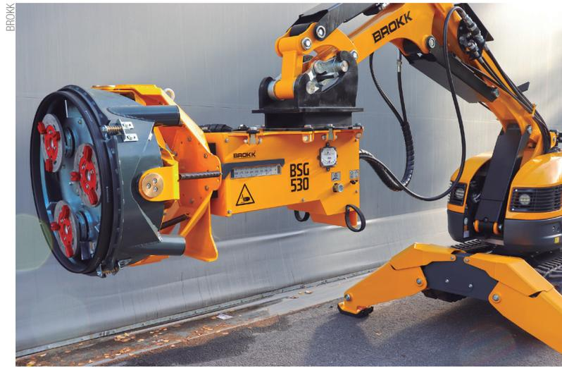
Retificadora de superfícies Brokk 530 é indicada para remoção de materiais
