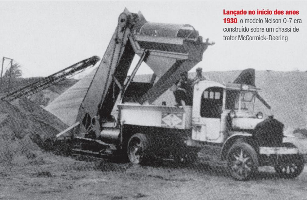
**Lançado no início dos anos 1930**, o modelo Nelson Q-7 era construído sobre um chassi de trator McCormick-Deering
