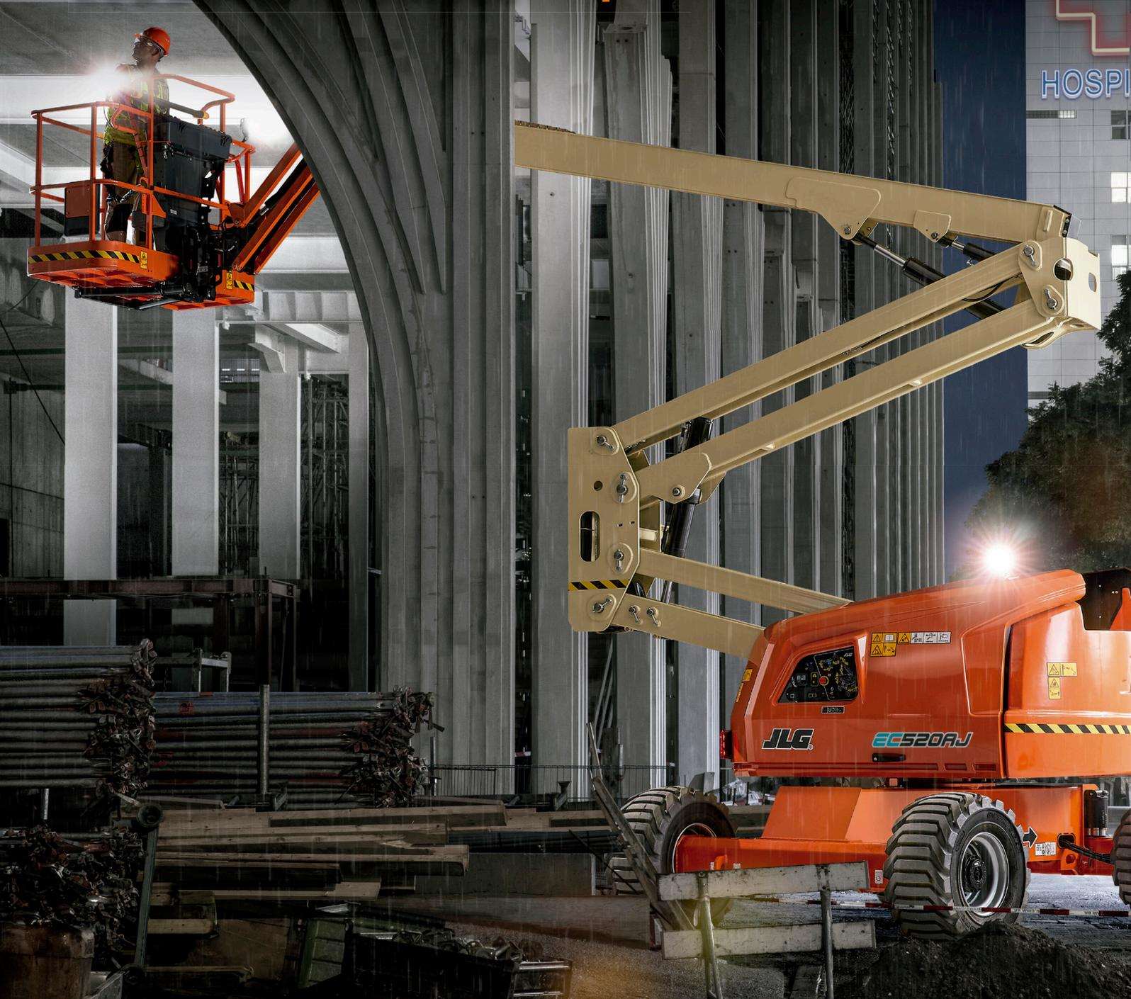
Agora você pode trabalhar em áreas delicadas sem perturbar o ambiente. Alimentado por baterias de íon de lítio de carregamento rápido e dois motores elétricos, as EC Booms da JLG oferecem operações limpas e maior eficiência energética em qualquer local de trabalho. Experimente um desempenho incomparável com a flexibilidade para trabalhos internos ou externos com uma única máquina.
