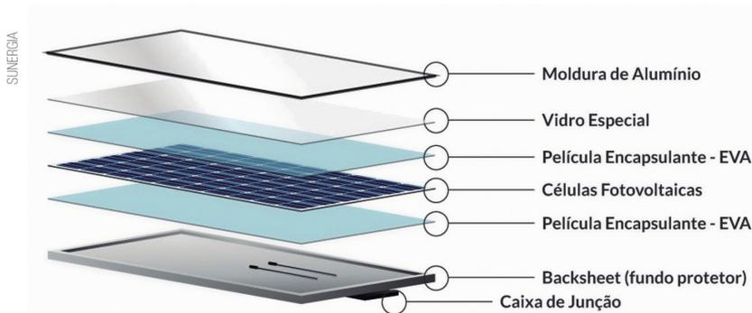
**Placas fotovoltaicas** são compostas por películas de proteção e vidro especial
