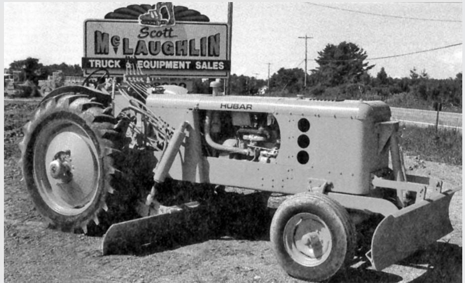
**Por volta de 1956**, a versão básica do modelo Huber Maintainer trazia controle hidráulico da lâmina e motor de 45 hp, além de uma ampla gama de implementos
