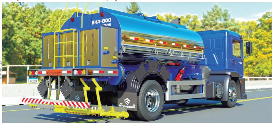
como polímero, fazendo a compensação entre a velocidade do veículo e o material. O produto traz novo sistema de barra espargidora deslizante com seleção parcial dos bicos, que possibilita diferentes configurações e regulação de altura e ângulo.
