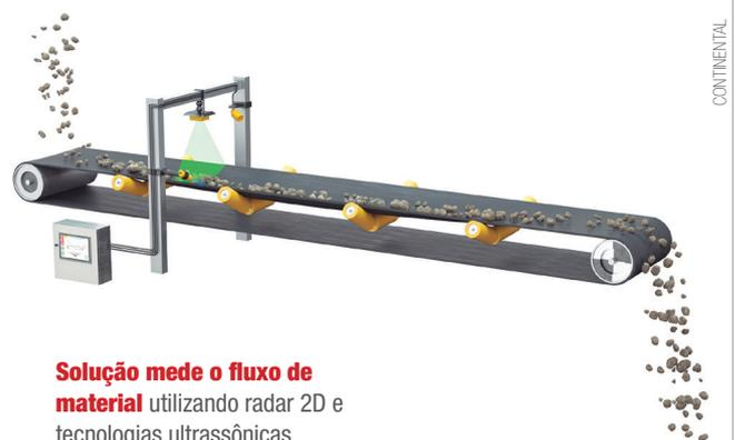
**Solução mede o fluxo de material** utilizando radar 2D e tecnologias ultrassônicas
