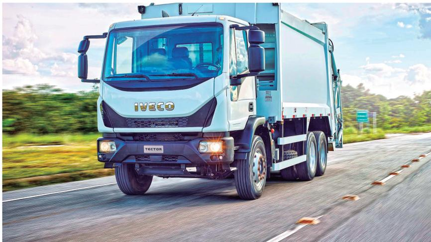
**Com motor de 300 cv**, o Tector Auto-Shift Coletor está disponível para aplicações 4x2 e 6x2
