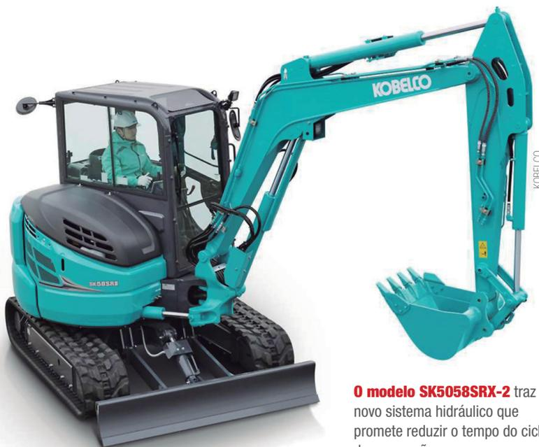
**O modelo SK50SRX-2** traz novo sistema hidráulico que promete reduzir o tempo do ciclo de escavação
