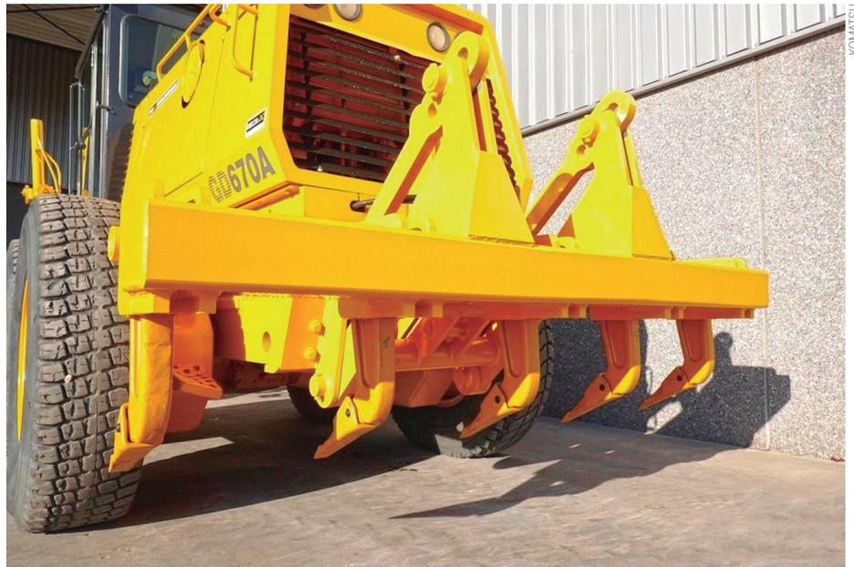
**Quando instalado na traseira**, o escarificador é usado para desagregar materiais de maior resistência
