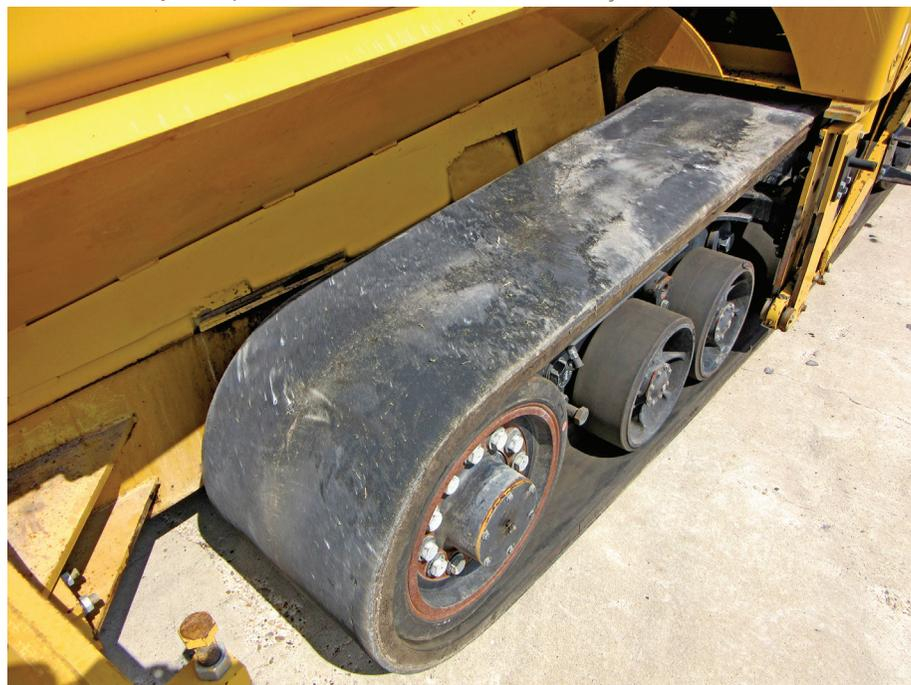
Como dificilmente deixa marcas no pavimento, a vibroacabadora de pneus é mais indicada para trabalhos em obras urbanas, onde há menos espaço para manobras ou necessidade de deslocamentos sobre um pavimento já existente. Por sua vez, com alto poder de tração e estabilidade, a vibroacabadora sobre esteiras leva vantagem quando a aplicação ocorre em grandes larguras ou bases.
