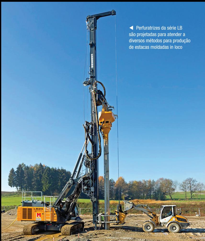
◀ Perfuratrizes da série LB são projetadas para atender a diversos métodos para produção de estacas moldadas in loco
