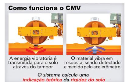
Baseada no acelerômetro, a tecnologia CMV indica a rigidez do asfalto em tempo real
