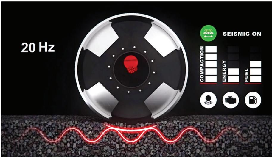
Sistemas como o Seismic propiciam compactação mais uniforme, ajustando o trabalho à frequência do solo
