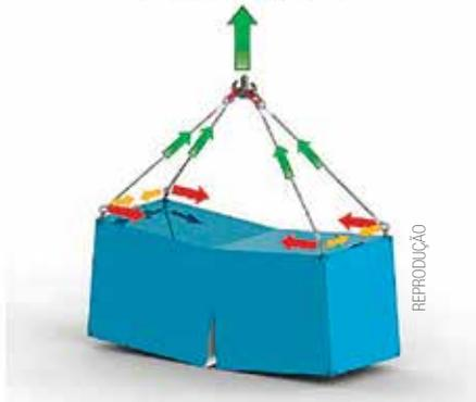
**Eslingas não são tensionadas** com a mesma força em todos os pontos
