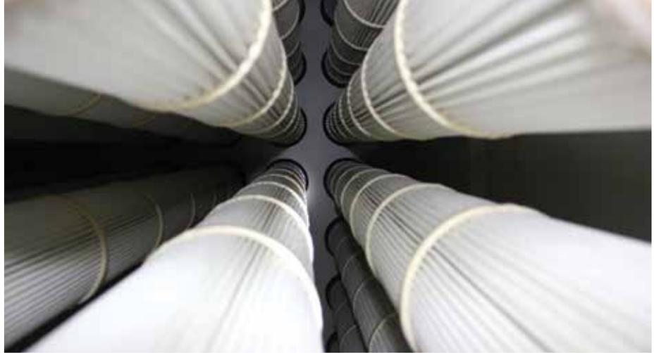
No alto, visão interna dos filtros com as mangas plissadas
