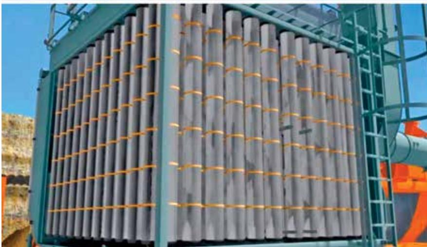
O fluxo dos gases gerados no queimador percorre todo o secador, passando pela tubulação de conexão de ar até chegar ao filtro. Na outra imagem, a caixa de filtro com as mangas, cujos tecidos retêm o pó e liberam os gases limpos
