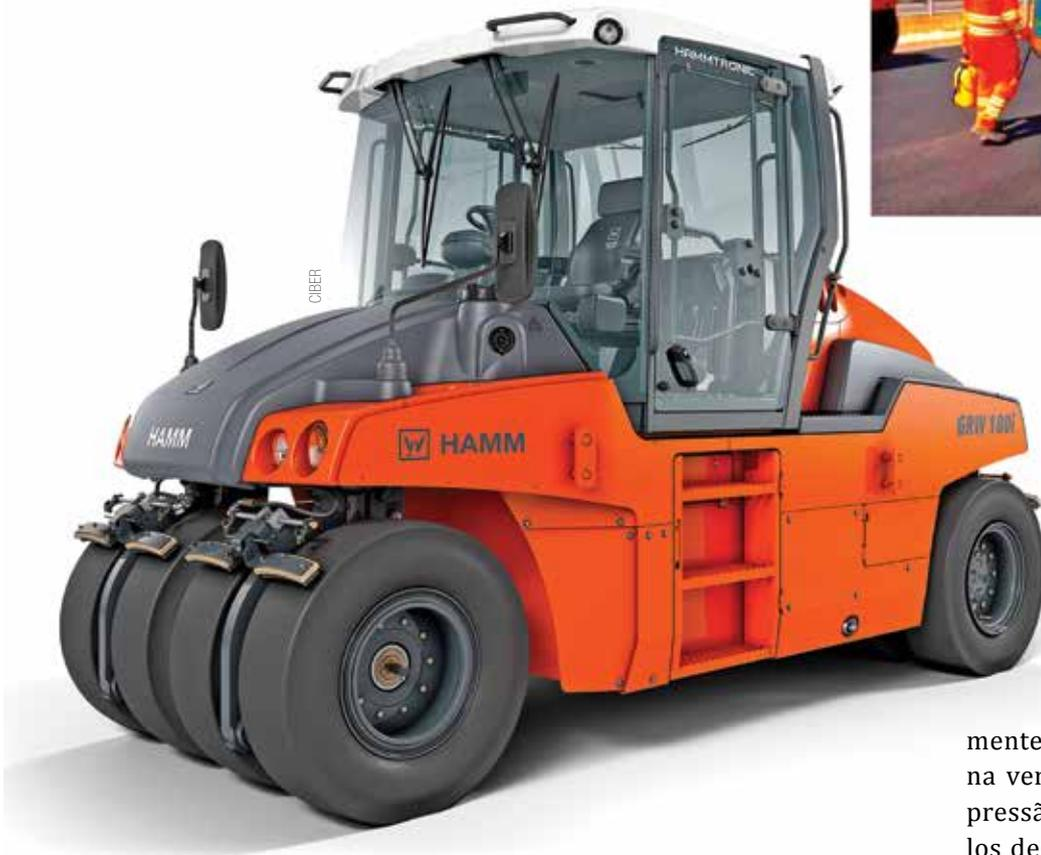
**Equipamentos mais modernos** fazem automaticamente a aspersão dos antiaderentes, evitando os riscos da operação manual (no detalhe)
