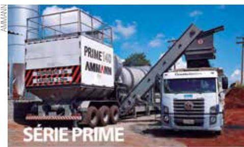
Composta por dois modelos (ACM 100 e ACM 140) de alto desempenho, a bem-sucedida série da Ammann adota as principais características de uma usina contínua, oferecendo um conceito integrado que inclui controles, tambor-secador, queimador, misturador e filtro.
