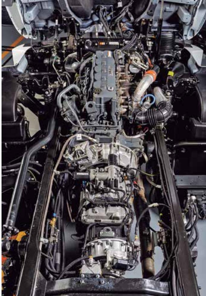
Motorização Cummins ISB 6.7 L de 306 cv entrega 1.100 Nm de torque
