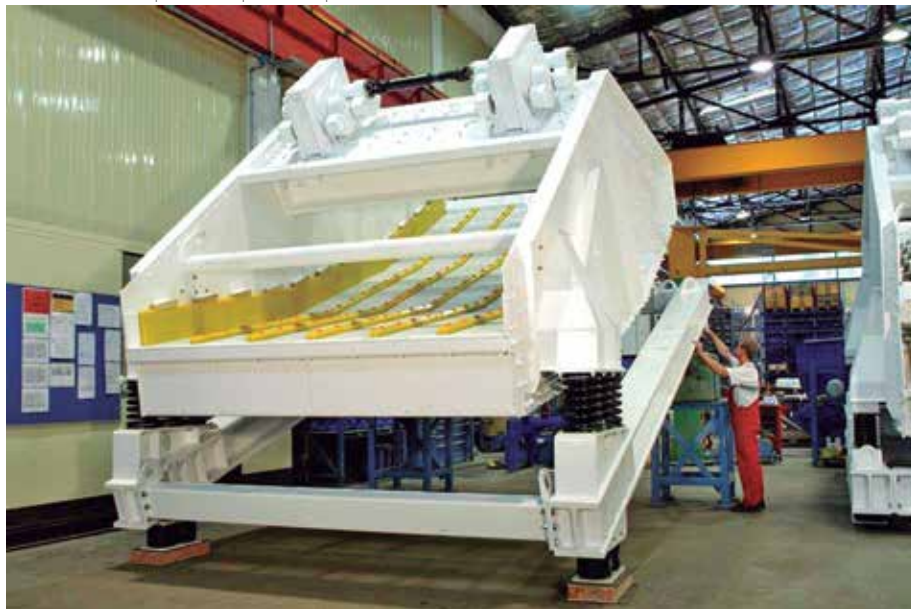
De alta eficiência para materiais com grande percentual de finos, o modelo Banana apresenta superfície de peneiramento com curvatura
