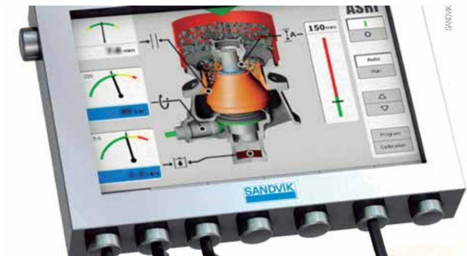
Recursos como o ASRi proveem informações como pressão, potência, abertura e desgaste dos revestimentos do britador
