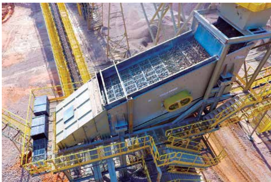
Peneira vibratória apresenta movimento elíptico, arremessando o material para o alto para ser classificado do deck
