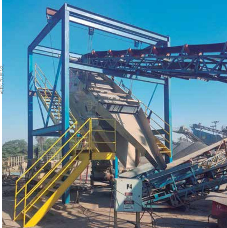
A Astec apresenta as peneiras de alta frequência Vari Vibe para classificação de materiais finos a seco
