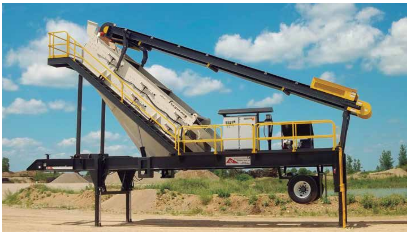
A peneira de alta frequência é utilizada para a separação de materiais granulados finos, em uma faixa granulométrica entre 0,05 mm e 5 mm
