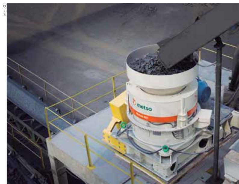
Exibido pela Metso , o novo britador de cone MX4 combina pistão e bojo giratório em um único equipamento
