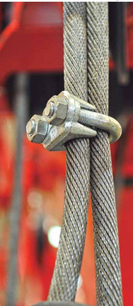
Outro critério é a redução do seu diâmetro por desgaste. Quando o cabo tiver se reduzido em 15% ou mais do diâmetro nominal, não poderá mais ser usado. O terceiro critério é a corrosão, que pode reduzir a força de ruptura estática do cabo devido à diminuição do seu diâmetro, afetando a segurança do serviço devido a pontos com ferrugem.
