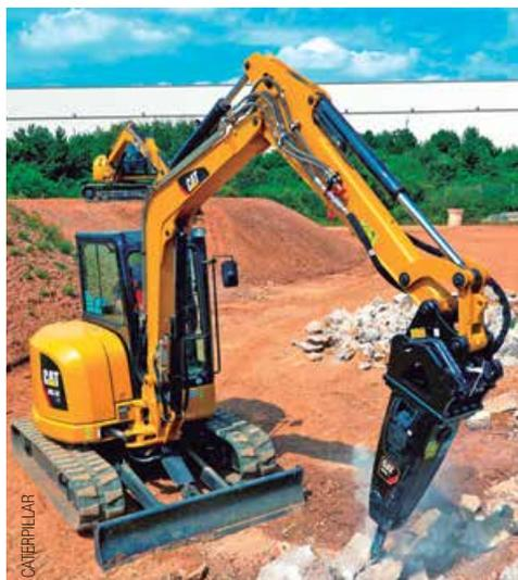
Tipo de material e quantidade de rompimento são os fatores que definem o modelo a ser utilizado
