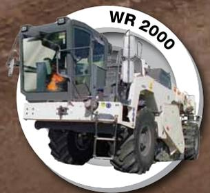
As Recicladoras a frio Wirtgen executam em uma única passada o corte das camadas e a mistura com cal, cimento ou espuma de asfalto.
