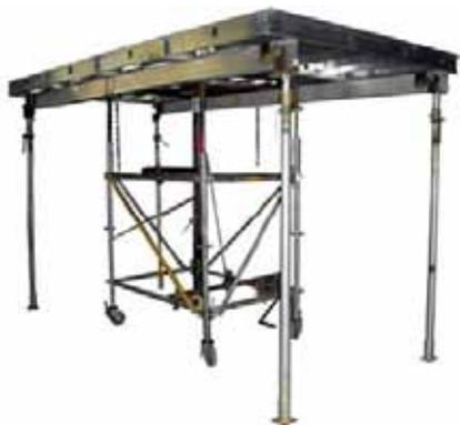
Lançada em setembro pela SH Formas, a mesa voadora Topec para execução de lajes é um sistema dois em um que combina a forma e parte do escoramento inicial. Segundo a empresa, o novo sistema reduz significativamente o índice de utilização de mão de obra e aumenta a produtividade, já que os módulos montados são transportados de uma laje para outra por uma grua, necessitando apenas de uma regulagem das escoras.
