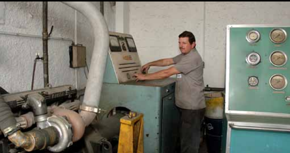
Teste de motor retificado com dinamômetro: equipamentos simulam carga
