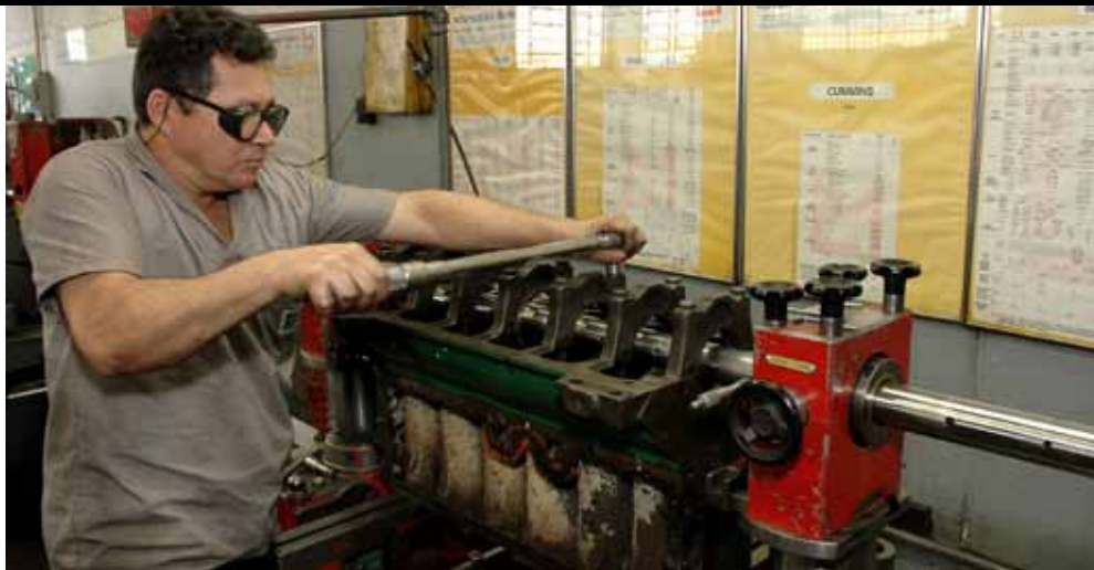
Alinhamento dos mancais
