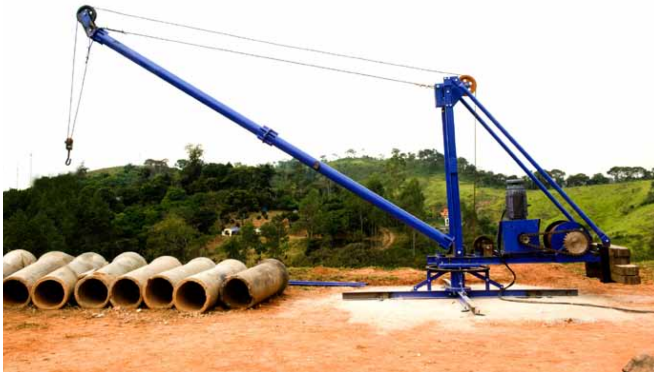
Minigrua da Montarte pode ser patolada em cima da laje ou acoplada à cremalheira de elevadores
