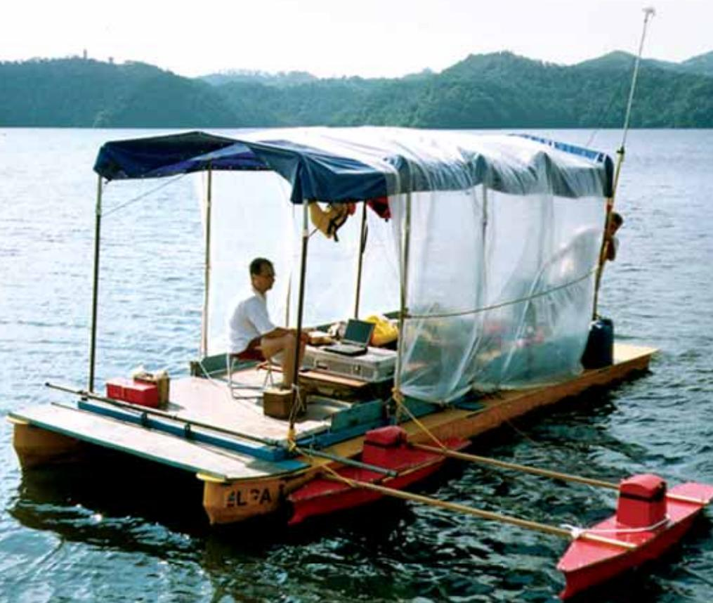
Souza explica que existem diversos métodos sísmicos indicados para investigação de superfícies submersas. Entre eles, o especialista destaca o sistema de perfuração sísmica contínua multifrequencial, cuja utilização é indicada para avaliação de cubagem de sedimentos no solo de rios, represas, áreas portuárias e costeiras. "Essa tecnologia gera informações necessárias para o correto dimensionamento do volume e da natureza do material a ser dragado, além de determinar a profundidade da rocha."
