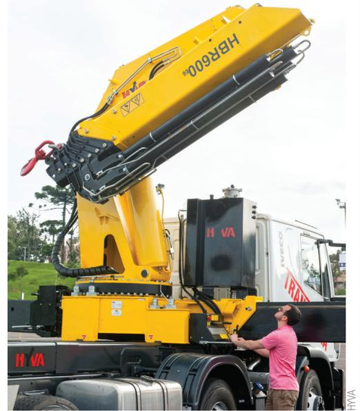
abrange equipamentos com capacidade entre 1 e 119 ton/m, incluindo tanto modelos fabricados localmente quanto importados. Os equipamentos da marca trazem como item de série um recurso que indica com sinal sonoro ou luminoso – ou ambos – se os estabilizadores estão abrindo. “Todos os equipamentos que produzimos são testados individualmente em bancadas hidráulicas, antes de saírem da fábrica”, ressalta Matos.
