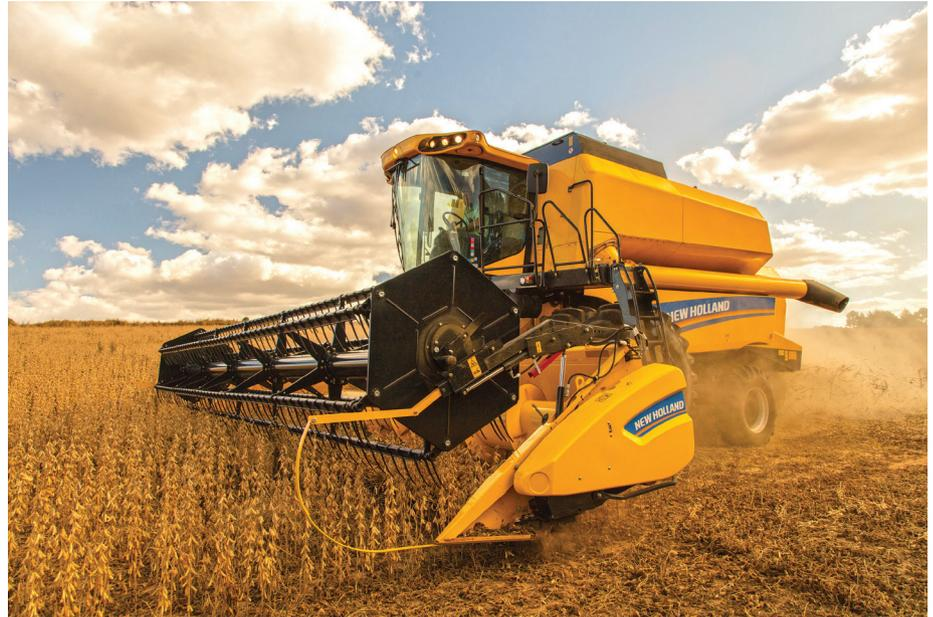
Com motor de 227 cv, modelo TC mantém sistema de saca-palha e separador rotativo
