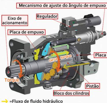
**Fig. 1 Fluxo de fluido hidráulico em sistemas de transmissão hidrostática**
