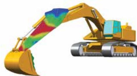
**Medição e análise das frequências** permitem determinar a causa da vibração
