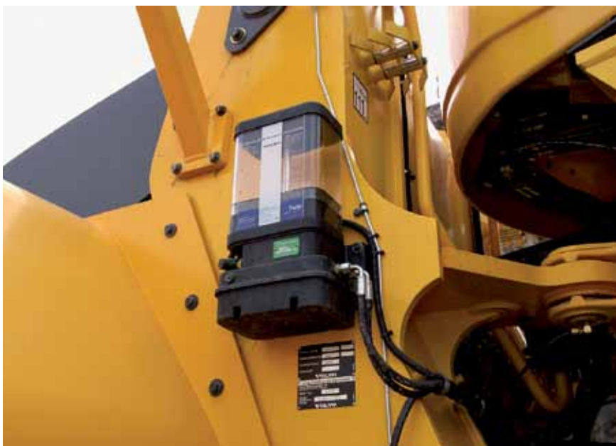
A lubrificação centralizada (abaixo) proporciona ganhos de tempo e de custo em relação à aplicação manual (acima) com maior qualidade no processo
