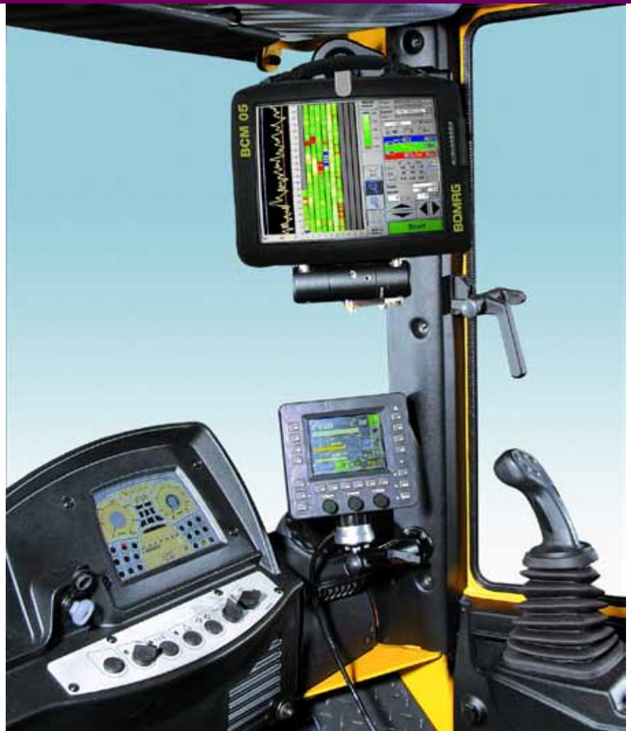
Sistemas monitoram a compactação a partir da cabine da máquina
