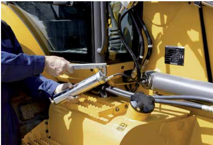
A lubrificação centralizada (abaixo) proporciona ganhos de tempo e de custo em relação à aplicação manual (acima) com maior qualidade no processo
